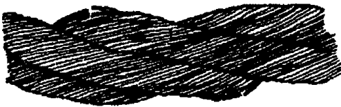
Рисунок 1. Обрывы и смещения проволок каната крестовой свивки
