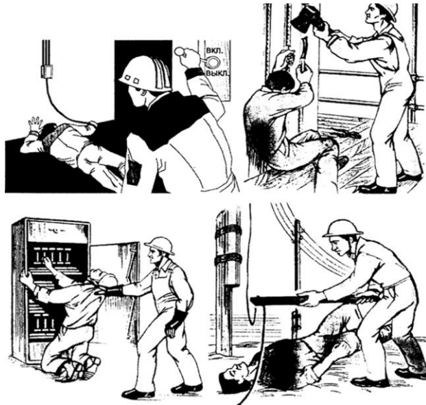
Рис. 1. Способы освобождения пострадавшего от действия электрического тока
