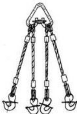
Строп канатный четырех- ветвевой типа 4СК1 ГОСТ 25573-82*
