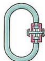
"Pov" - с замком грузоподъемность до 2 т
