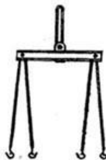
Траверса для подъема и монтажа железобетонных стеновых панелей
