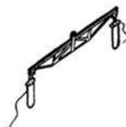
Траверса универсальная для подъема ферм, балок
