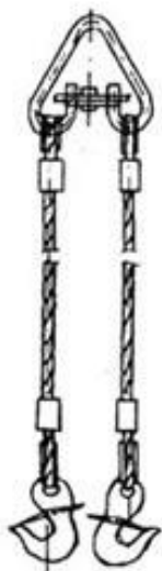
Строп канатный двух- ветвевой типа 2СК ГОСТ 25573-82*
