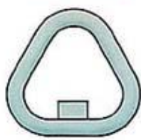
"Т" - с одним упором, грузоподъемность до 12,5 т
