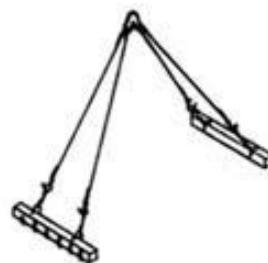
Траверса для подъема карт из профнастила
