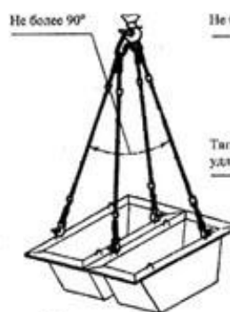
Строп 4 СК1-3,2+4 СК1-10,0 Q = 3,2+10,0 тс при подаче пустой тары P=54x2=108 кг
