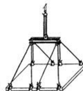
Траверса Т-1 Q=8,0 тс при монтаже плит
