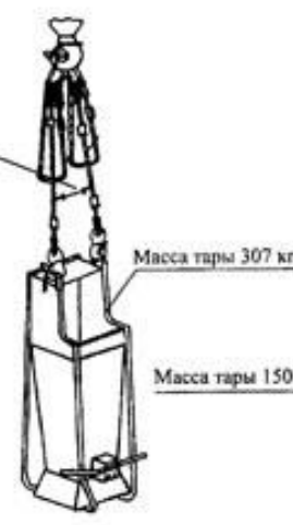
Строп 4СК1-10,0 Q=10,0 тс при подаче бункера(бады) с бетонной смесью V=1 м 3 Р=3,0 т
