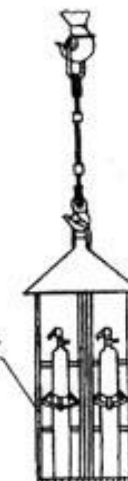
Строп 1СК-2,5 Q=2,5 тс при подаче контейнера для хранения баллонов Р=750 кг
