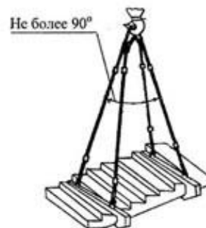
Строп 4 СК1-3,2+4 СК1-10,0 Q = 3,2+10,0 тс при подаче ящика с цементным раство- ром емкостью 0,28 м 3 P = 0,65 т
