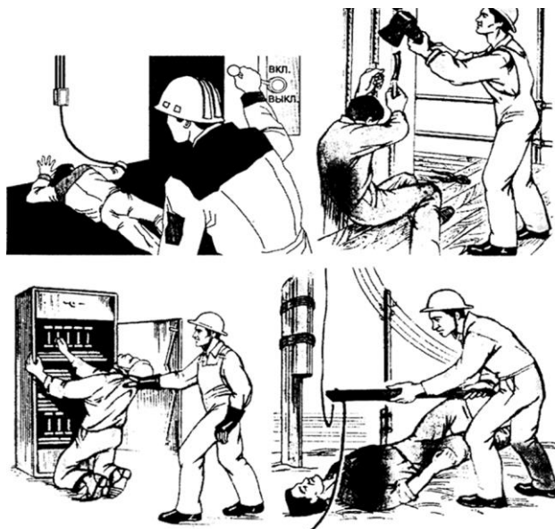
Рис. 1. Способы освобождения пострадавшего от действия электрического тока
