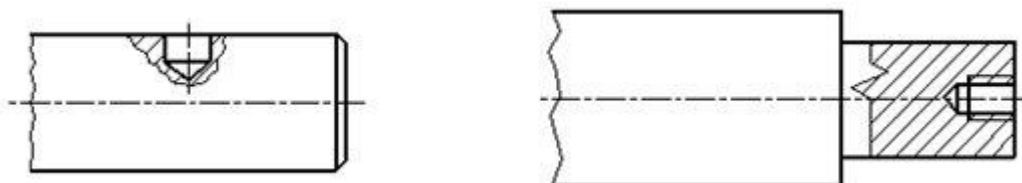
Рисунок 41 - Пример изображения местных разрезов на валах
