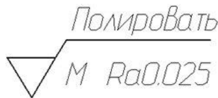
Рисунок 91 - Обозначение шероховатости поверхности с видом обработки
