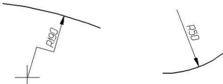
Рисунок 75 - Примеры нанесения размера радиуса
