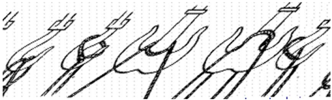
Закрепление стропов на крюке
