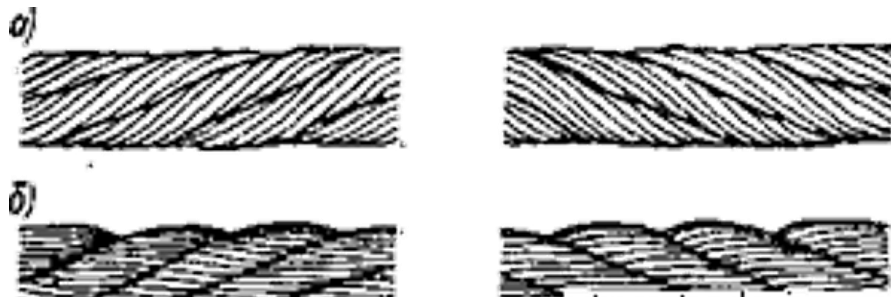
Стальные канаты односторонней (а) и крестовой (б) свивки бб
