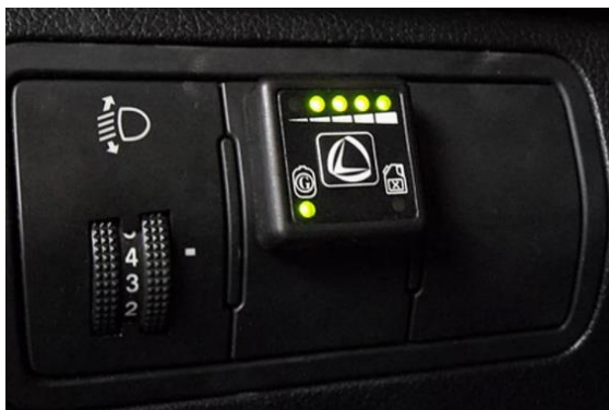
Рис. 5.25. Установка переключателя «Бензин» - «Газ» в салоне современного автомобиля.
