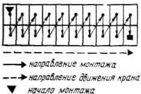
Рис. 8.27. Схема поэтажного монтажа с использованием башенного крана
