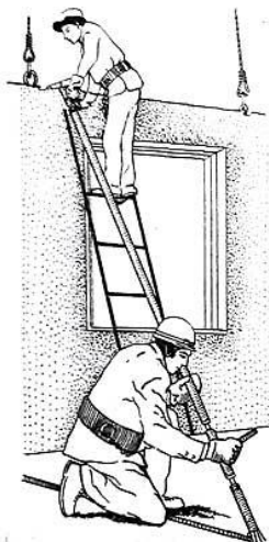
Рис. 8.22. Выверка стеновой панели с помощью подкоса и накладных струбцин
