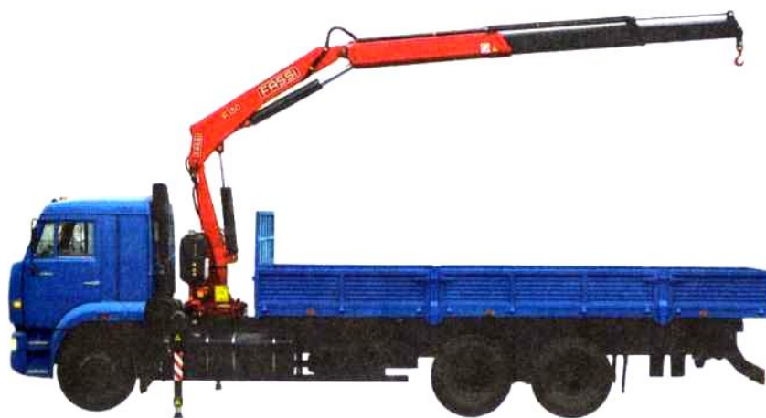
Рис. 12а. КМУ Fassi F150 (с жёсткой подвеской грузозахватного органа) на КАМАЗ-53212
