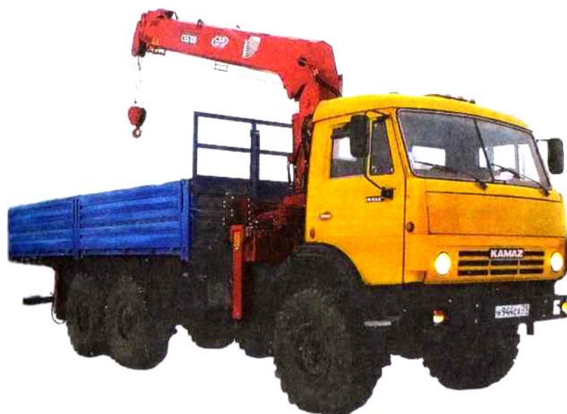
Рис. 12б. КМУ CS Machinery CSS106 (с гибкой подвеской грузозахватного органа) на КАМАЗ-43118
