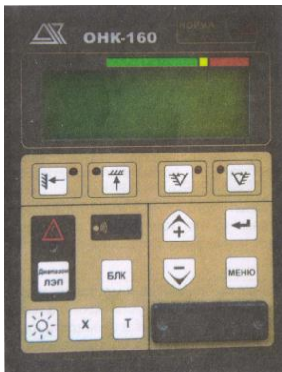
Ограничитель нагрузки крана ОНК-160С
