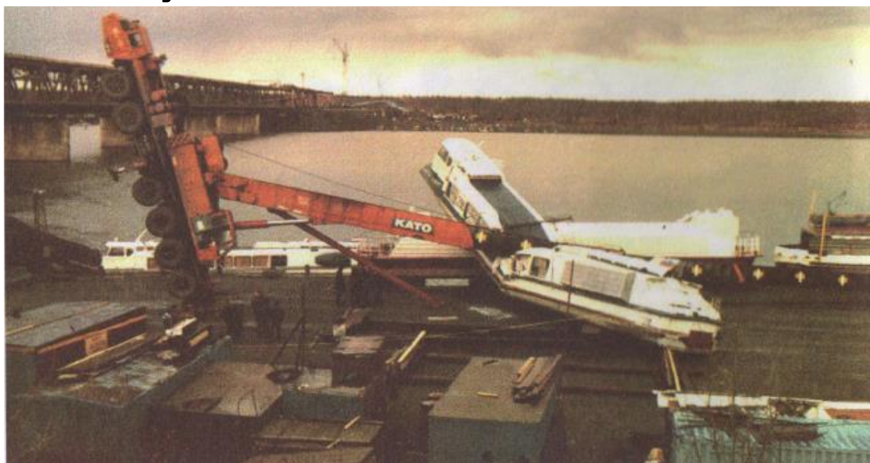
На фото: авария крана KATO NK-1200 при установке судна «Заря» на зимнюю стоянку
