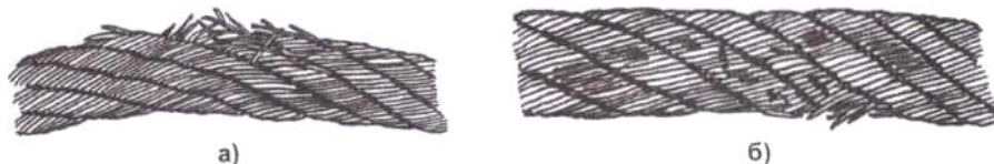
Рис. 26. Обрывы проволок в зоне уравнительного блока: а - в нескольких прядях каната; б - в двух прядях в сочетании с местным износом
