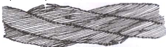
Рис. 24. Обрывы и смещения проволок каната крестовой свивки
