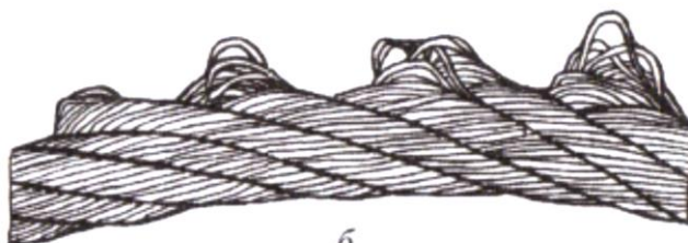
Рис. 35. Выдавливание проволок прядей: а - в одной пряди; б - в нескольких прядях
