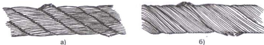
Рис. 25. Сочетание обрывов проволок с их износом, а - в канате крестовой свивки; б - в канате односторонней свивки
