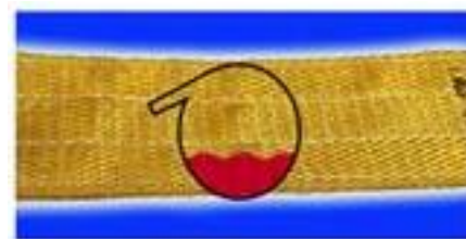
Повреждение в результате воздействия кислоты/щелочи
