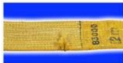
Повреждение главного шва
