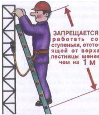
Рис. 60. Работа с лестницы
