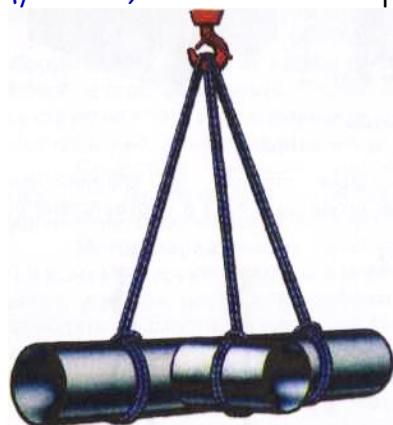
Рис. 66. Стropовка пространственных конструкций трубопроводов
