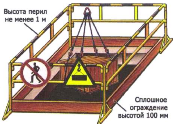
Рис. 57. Ограждение люка и сигнальные знаки
